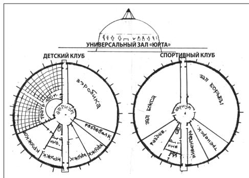
Конструктивная схема типа «Юрта» создает безопорное планировочное пространство для разных функций. Отсутствие фундамента обеспечивает абсолютную антисейсмичность. Быстровозводимое сооружение (90 раб. дней). г. Улан-Удэ, телефон: 89025646381, 89969354210.
