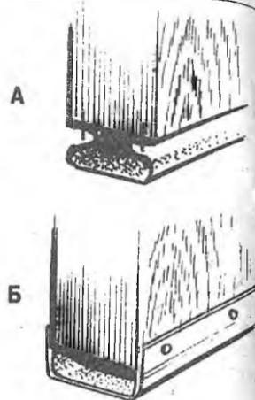
Чтобы под двери комнаты дуло, не проникал шум и запахи на их нижний торец прибивается уплотнительный валик. Если дверь легко снимается с петель, его крепят, как показано на рис. А - тогда он не виден. Если это проделать трудно, то валик крепят как на рис. В.
