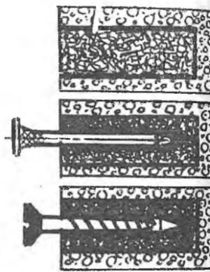
Деревянные пробки для шурупов со временем рассыхаются и выпадают из стены. Не торопитесь вырезать новую пробку. Плотно набейте в отверстие капрон из старого чулка. Нагретым докрасна гвоздем подходящего диаметра выплавьте отверстие для шурупа. Расплавившийся капрон превратится в прочную пробку.
