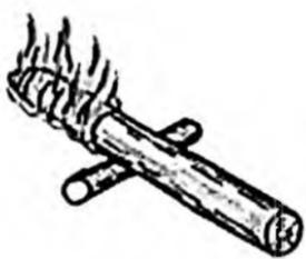
Чтобы закопанные в землю деревянные столбы не гнили, их концы обжигают в костре. Сделать это так, чтобы древесина со всех сторон обгорела равномерно, трудно. Можно поступить проще: обернуть обжигаемую часть бревна веткой или просто ненужной тряпкой, смоченной в керосине или отработанным масле, и поджечь.
