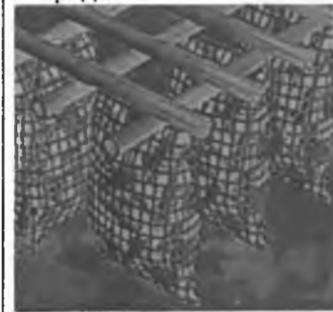
Деталь каркаса острова: бутылки заключены в сетки, закрепленные на бамбуковой решетке.
