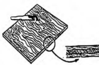
Чтобы отпиленный край фанеры был ровным, прорежьте острым ножом ее верхний слой вдоль линии разреза: заусенцев на распиле не будет. Есть и другой способ: смочите поверхность фанеры вдоль линии разреза горячей водой. Она поможет распилить и асбоцементный лист, так как размягчает поверхность листа, и он режется значительно легче.
